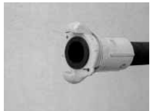
Bild 3: Strahlschlauchkupplung mit Sicherheitssplint.
